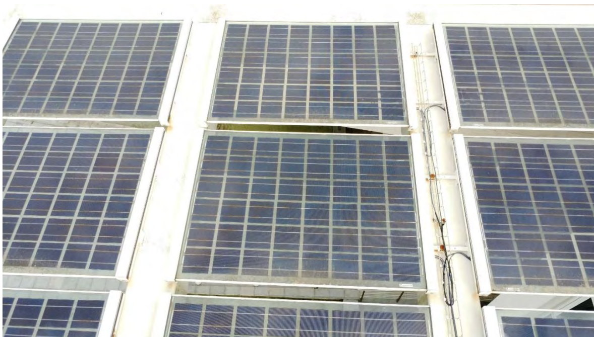
– Moduli vetro-vetro con evidenti segni di ossidazione dei contatti delle celle
