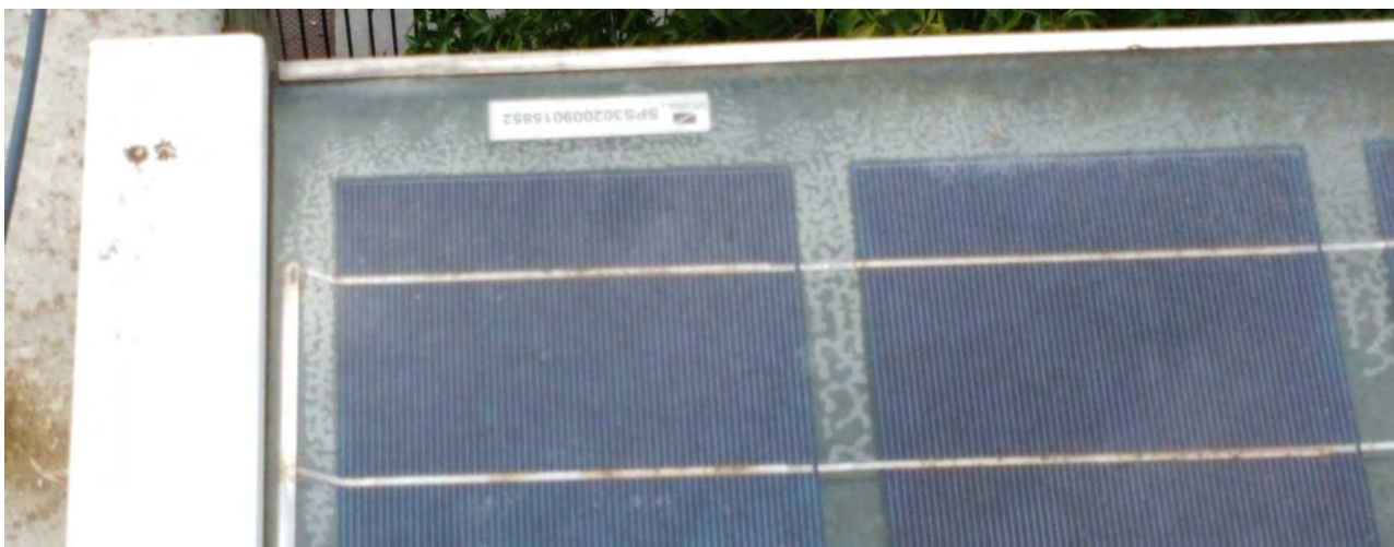
– Moduli vetro-vetro con evidenza di distacco della lasta di vetro dalla cella
